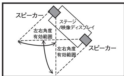
②通路に向けてスピーカーを設置する場合は、スピーカーの中心軸が通路を挟んで隣接する小間との境界中心線を越えてはなりません。スピーカーを造作物に組み込む場合も同様とします。
