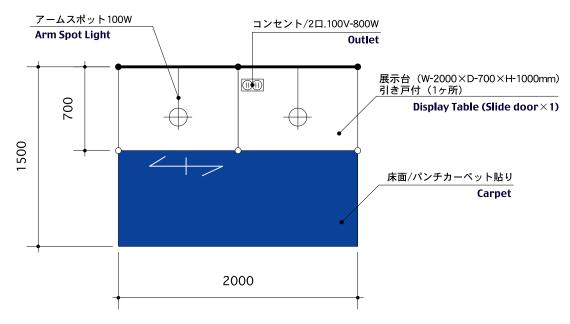
■ 壁面:システムパネル(白) W-2000×H-2700 Wall Panelling: System Wall (White)
